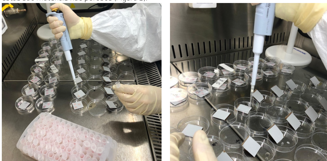
Figura 5: Superfícies analisadas inoculadas com gotículas carregadas com vírus (SARS-CoV-2).
